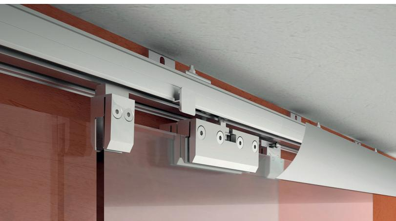
Sistema scorrevole con binario a due vie che permette lo scorrimento parallelo a trascinamento, sia in apertura che in chiusura, di 2 ante mobili per parte. La veletta dalle dimensioni ridotte di 103 mm di altezza, racchiude un meccanismo robusto che supporta applicazioni a muro e a soffitto in quattro varianti. Soluzione ideale per chiudere grandi luci fra due ambienti.
