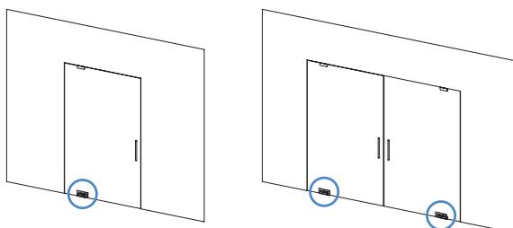
Con un'UNICA cerniera si sorreggono porte pesanti senza variare il comportamento di chiusura che resta automatico. La variante a bilico permette l'applicazione su vani porta più ampi, mantenendo massima stabilità e sicurezza in un minimo ingombro.
