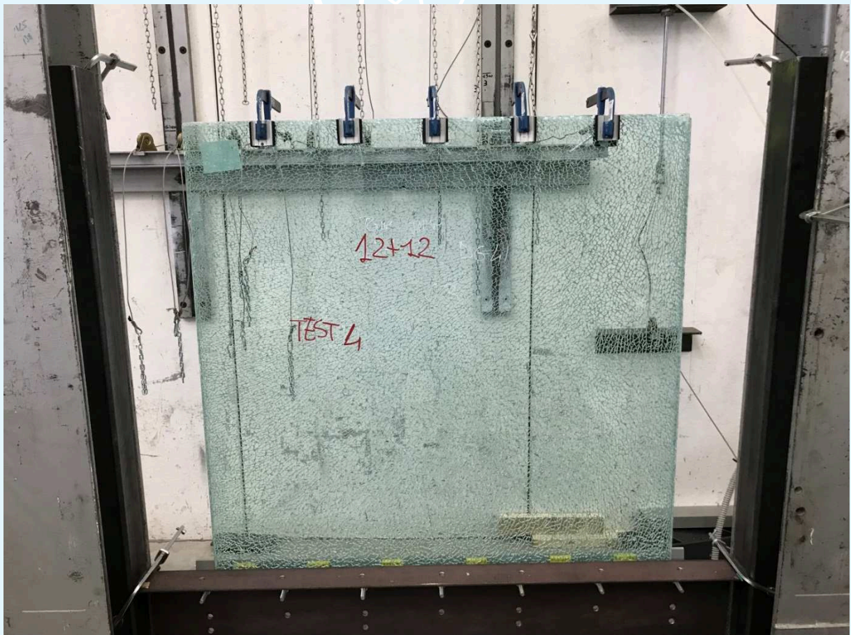
Fotografia del campione dopo la rottura indotta.
